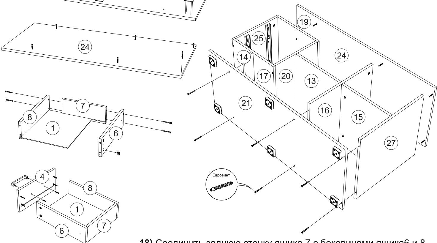
**18)** Соединить заднюю стенку ящика 7 с боковинами ящика 8 евровинтами, предварительно вставив дно ящика 1 в соответствующие пазы.
