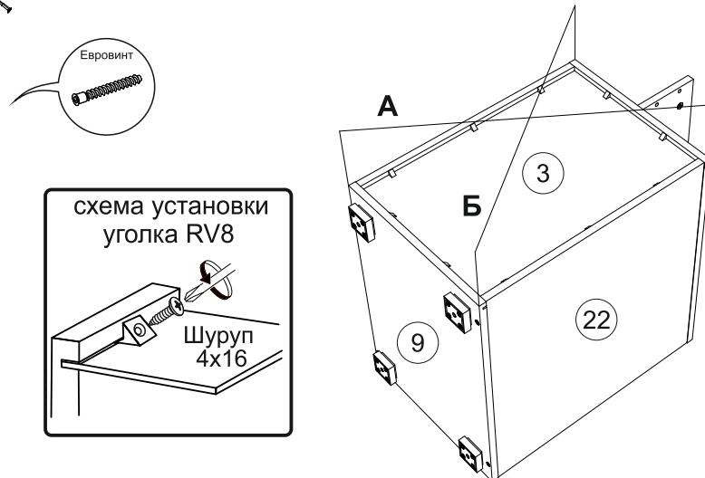
**5)** Заднюю стенку 3 зафиксировать к боковинам и крышкам уголками Rv8 при помощи шурупов 4x16, предварительно выровняв диагональ при помощи рулетки.
