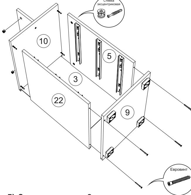
**3)** Установить штоки эксцентриковых стяжек на крышку 10. Соединить крышку 10 с перегородкой 23, используя евровинты.
