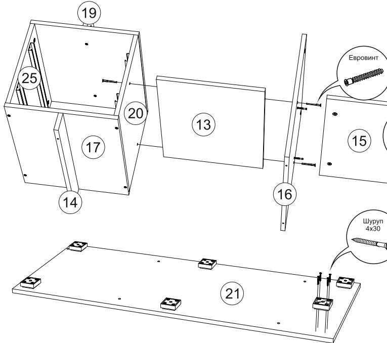
**15)** Соединить вязку 13 с боковиной 20 и перегородкой 16 евровинтами. Закрепить вязку 15 к перегородке 16 и к боковине 27 эксцентриковыми стяжками.
